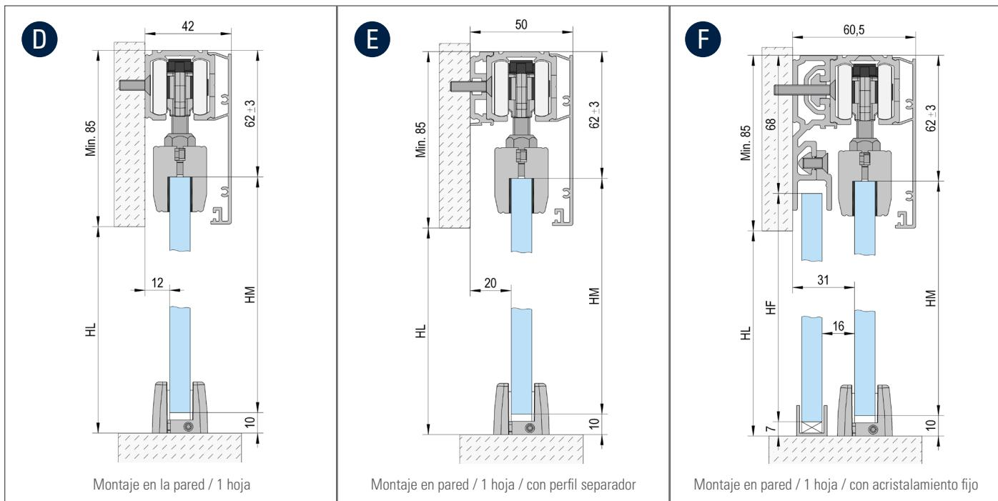
Altura del vidrio (HM) = HL + 15 mm / Parte fija del vidrio (HF) = HL + 10 mm
