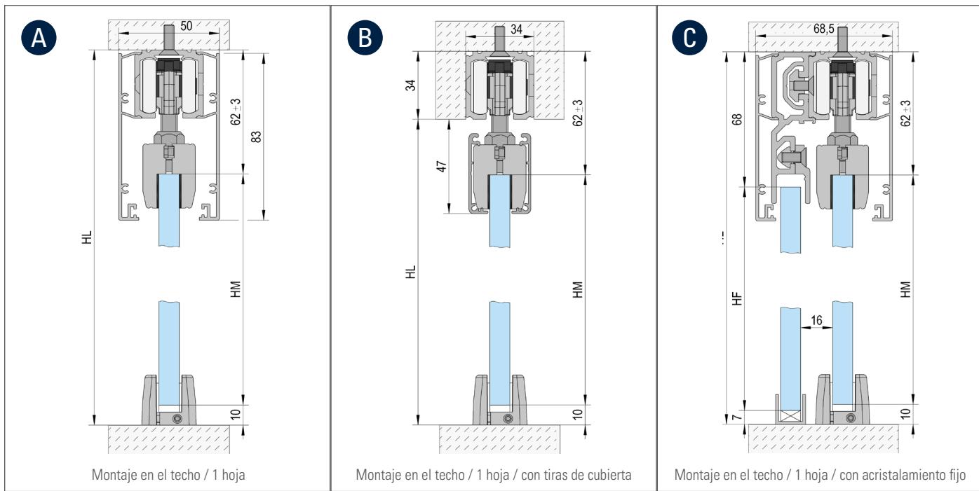
Altura del vidrio (HM) = HL - 70 mm / Parte fija del vidrio (HF) = HL - 75 mm
